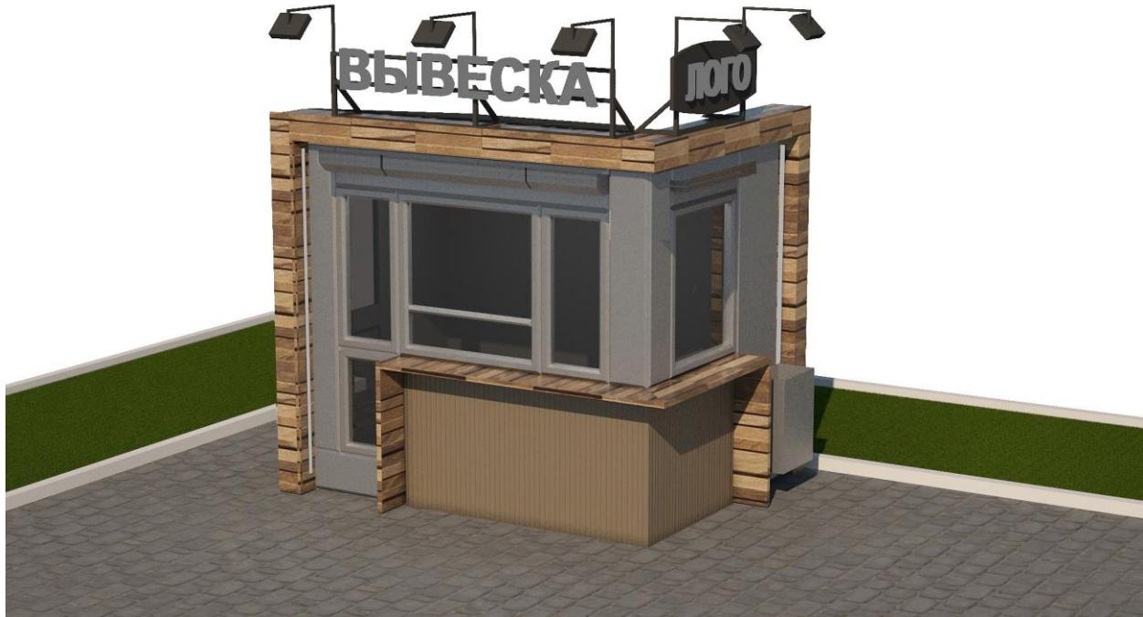
Конструктивная схема – металлический или иной каркас с заполнением утеплителем. Облицовка наружных стен киоска – металлокассеты. Цвет по цветовому стандарту RAL – оттенки серого (RAL 7004, RAL 7005, RAL
