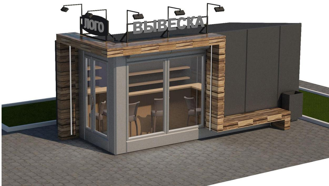
Конструктивная схема – металлический или иной каркас с заполнением утеплителем. Облицовка наружных стен павильона – металлокассеты. Цвет по цветовому стандарту RAL – оттенки серого (RAL 7004, RAL 7005, RAL
