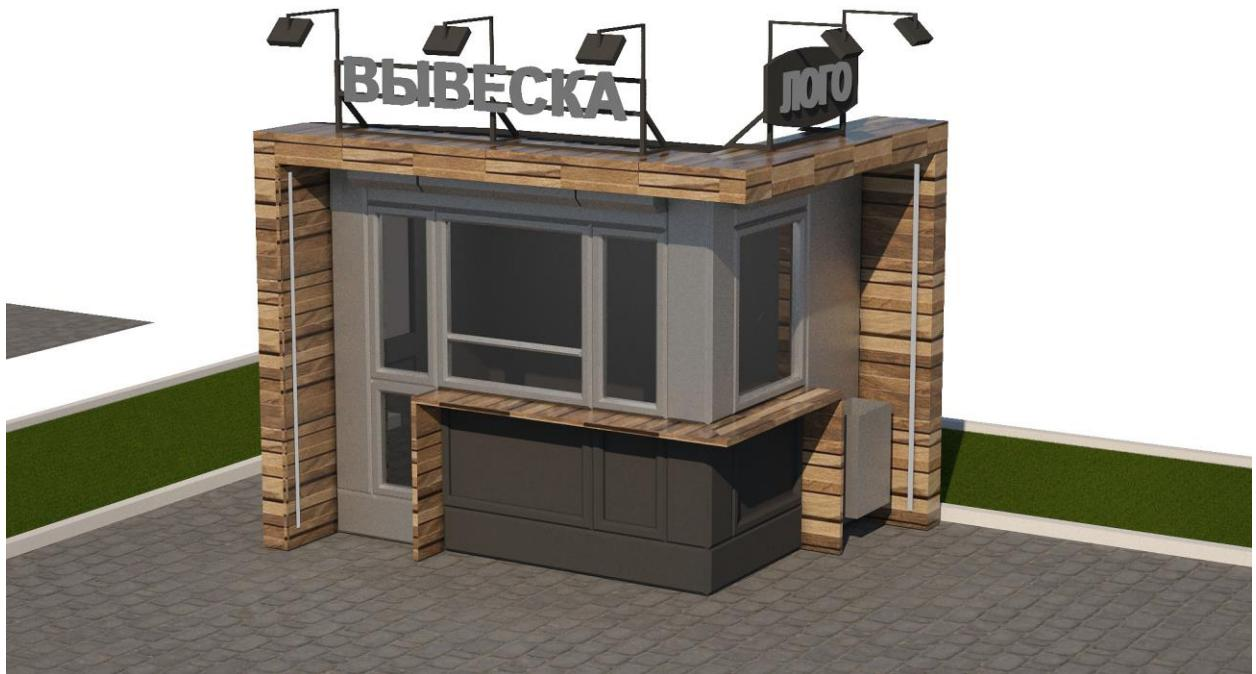
Конструктивная схема – металлический или иной каркас с заполнением утеплителем. Облицовка наружных стен киоска – алюминиевый композитный материал. Цвет по цветовому стандарту RAL – оттенки серого (RAL 7004, RAL 7005, RAL 7022).
